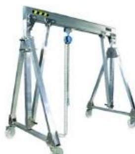
Portique d'atelier aluminium déplaçable en charge (sur sol propre et lisse) et pliable Capacités de 0.25 à 2 tonnes. Hauteur sous fer réglable Portées de 2 à 6.5m. (Préciser avec palan manuel ou sans)
